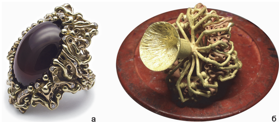
Рис. 2. а – каблучка “Hybrid casting #2: Carménère”. Золото рожевого та жовтого кольору, дорогоцінне каміння. Подвійне литво. Viaurium; б – необроблена частина каблучки після подвійного литва. Viaurium
