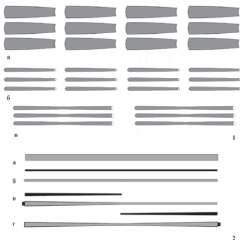
Рис. 4. 1-2 – два способа изготовления биконических полых трубок.
