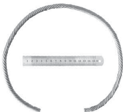
Рис. 6. Жгут гивны, изготовленный во время эксперимента.
