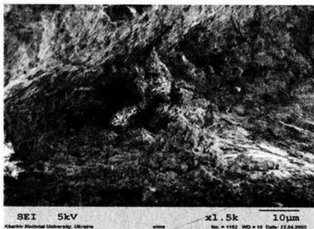
Рис.4 - Внутренняя поверхность золотной нити из слепа 612 под электронным микроскопом (увеличение в 1500 раз). На изгибе нити хорошо видны остатки сильно деструктурированной органики, природу происхождения которой установить не удалось.
