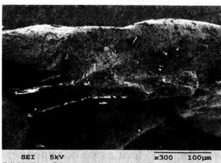
Рис.7 - Внешняя поверхность золотной нити из слепа 612 под электронным микроскопом (увеличение в 300 раз). Хорошо видна толщина раскатки металла, которую (даже визуально) можно соотнести с масштабом съемки в 100 микрон.
