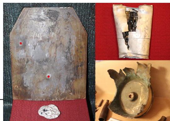
Рис. 7. Бронепластина з наскрізними кульовими отворами, фрагменти здетонованих боєприпасів
