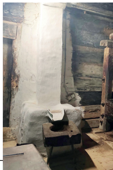
Рис. 3. Піч для обсмажування олійної сировини – «панва», у будівлі олійні с. Головецько, МНАП у Львові
