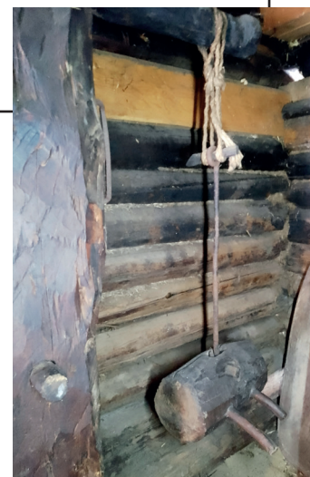
Рис. 17. Кріплення таранів у пресі із с. Пилипець. МНАП у Львові. Фото 2023 р.
