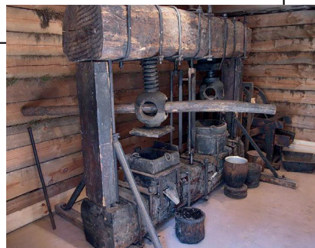
Рис. 7. Олійний прес із гвинтами. Музей-скансен «Zagroda Kurpiowska w Kadzidle». Польща
